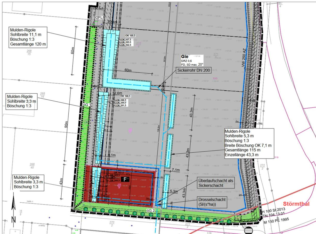
Abb. 10 Mögliche Anordnung aller Mulden-Rigolen, sowie Verbindungsleitungen
